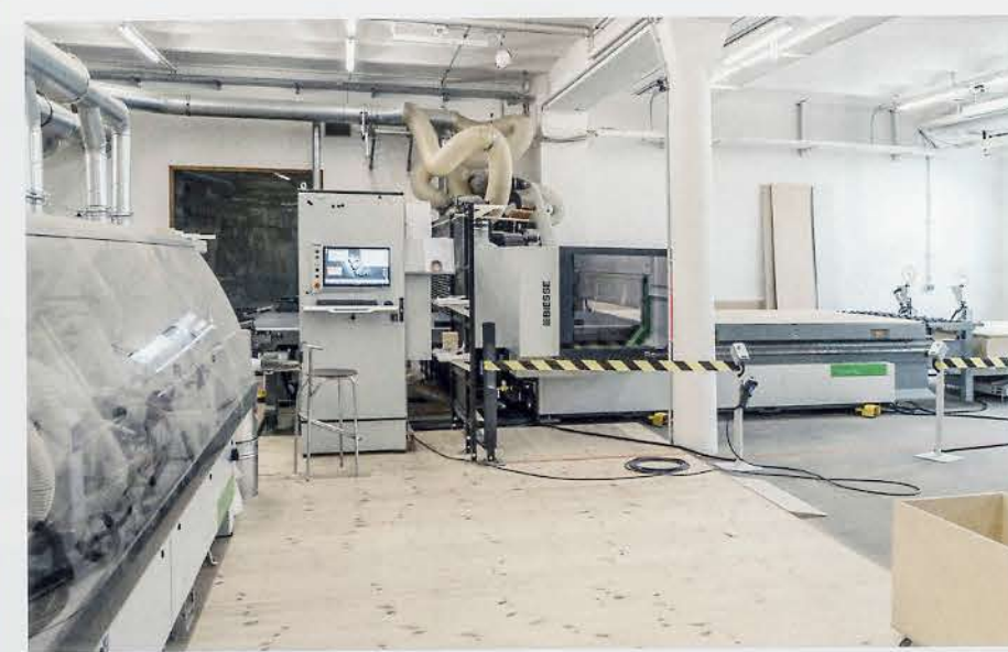
Die neue Zelle für Möbelteile: links der Bekanter, rechts die Nesting-CNC
