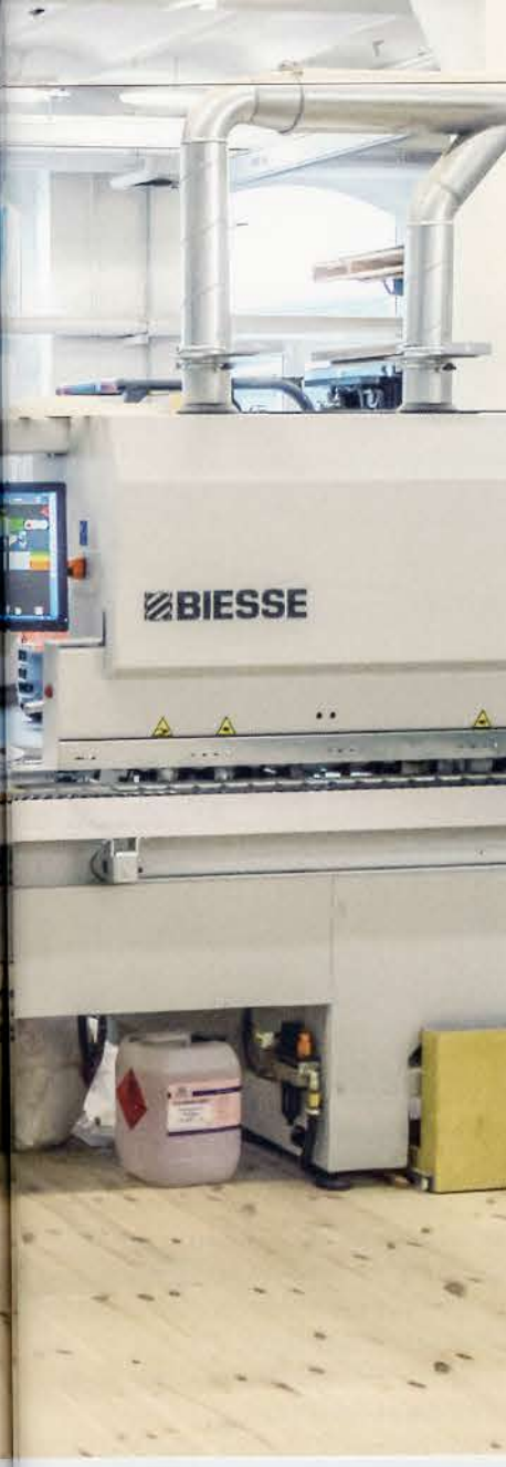
Nur zwei Schritte von der CNC zum Bekanter erübrigen das Zwischenstapeln
